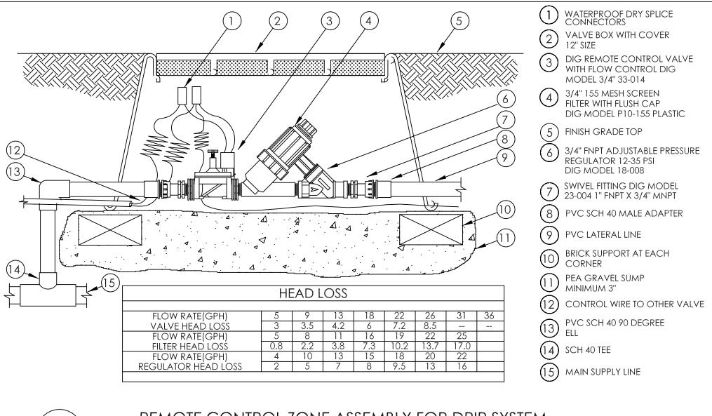
REMOTE CONTROL ZONE ASSEMBLY FOR DRIP SYSTEM
